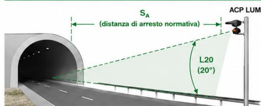
Figura 2 – Posizionamento e campo visivo del lumenometro ACP LUM
