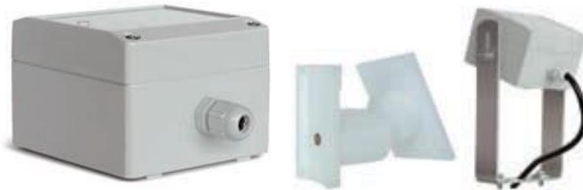
Mikroprozessor gesteuerter Radardetektor mittlerer Reichweite für bewegungs- und geschwindigkeitsabhängige Schaltanwendungen. Detektiert werden Fahrzeuge und Personen, die sich in seinem breiten Erfassungsbereich nähern und / oder entfernen (Bewegungsrichtung einstellbar).
